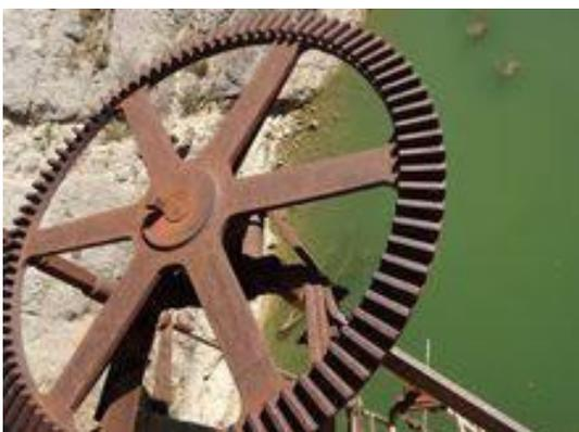
Vue splendide sur le barrage avec une roue dentée qui permet de vider les fonds.
