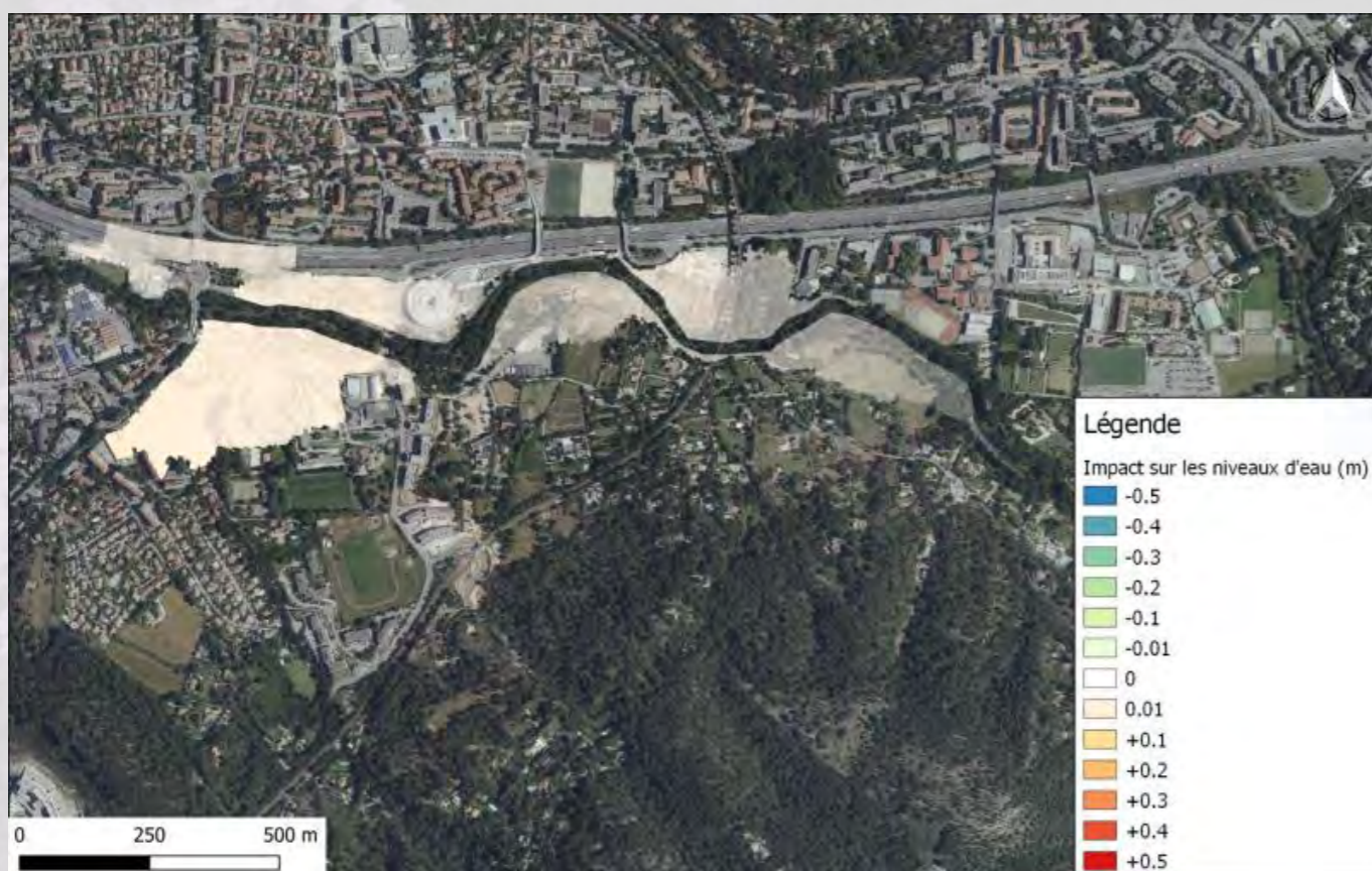
Impact sur les niveaux d'eau de la crue de référence
