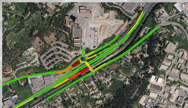
Remontées de files maximales au droit de l'échangeur en Heure de Pointe du Soir (HPS)
