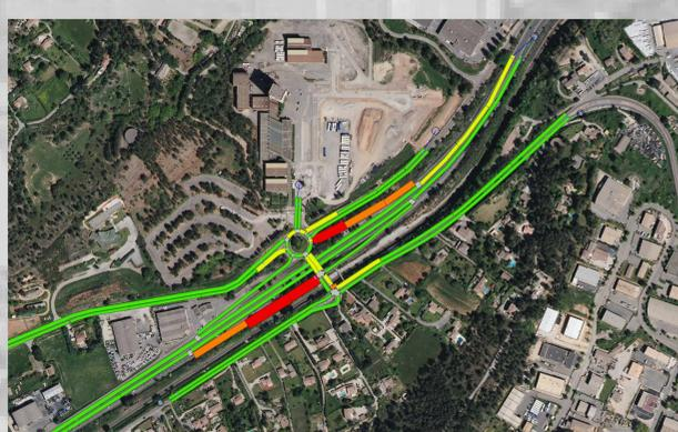
Remontées de files maximales au droit de l'échangeur en Heure de Pointe du Matin (HPM)
