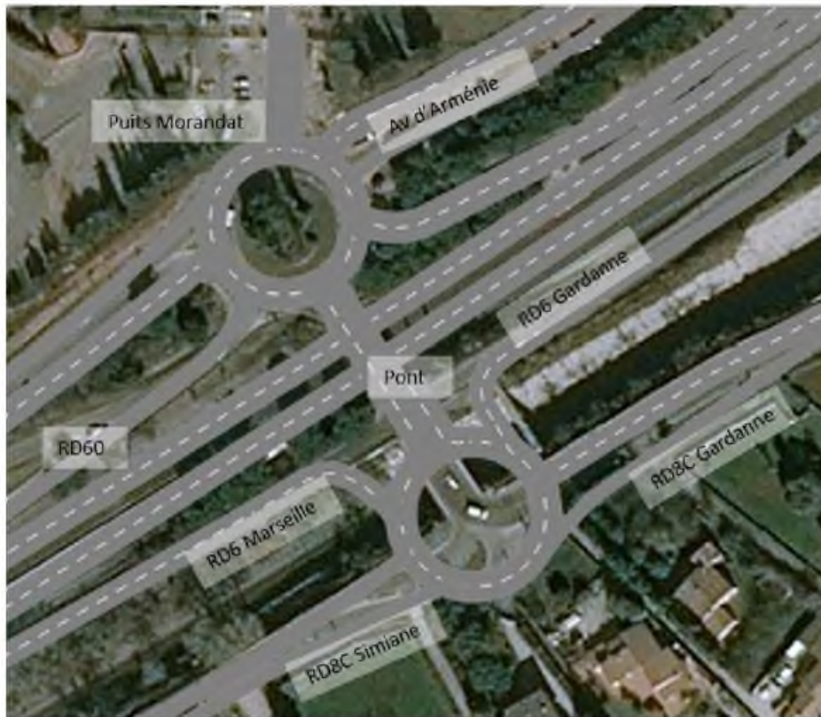
Aménagement proposé par le scénario 7 (fonctionnement à deux giratoires)
