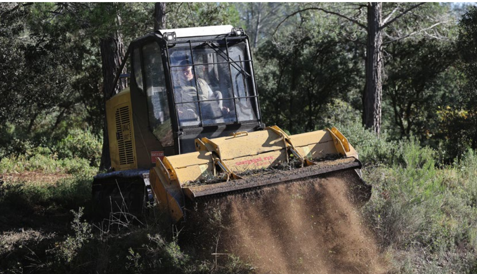
L'Unac 160, un tracteur à chenilles de 160 chevaux, permet de débroussailler des terrains difficiles d'accès.
